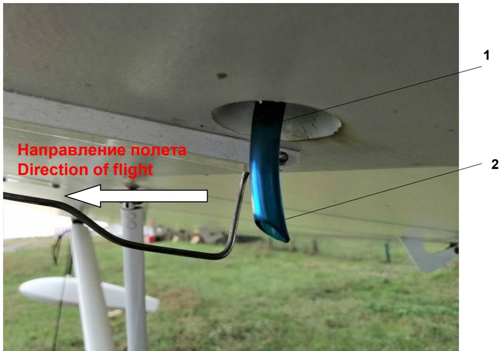
1 Трубопровод дренажа топливных баков / Fuel tank drain pipeline    2 Патрубок ПВХ 6 x 9 МБС / PVC tube 6 x 9 MBS
